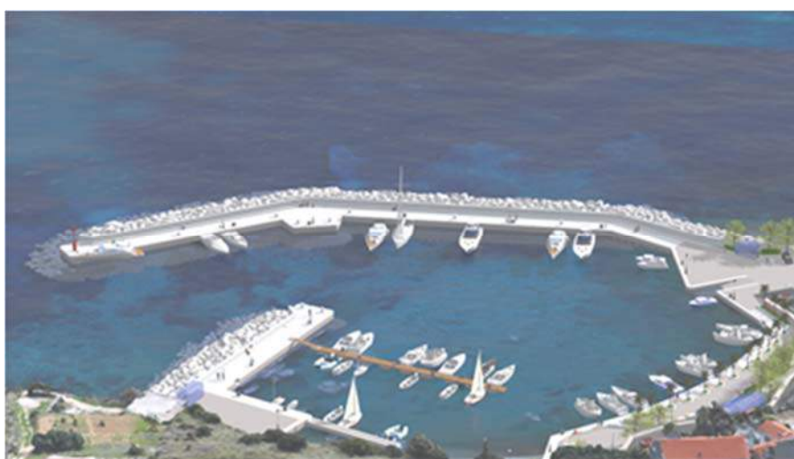
Slika 2.2.-5. Planirani izgled glavnog lukobrana
